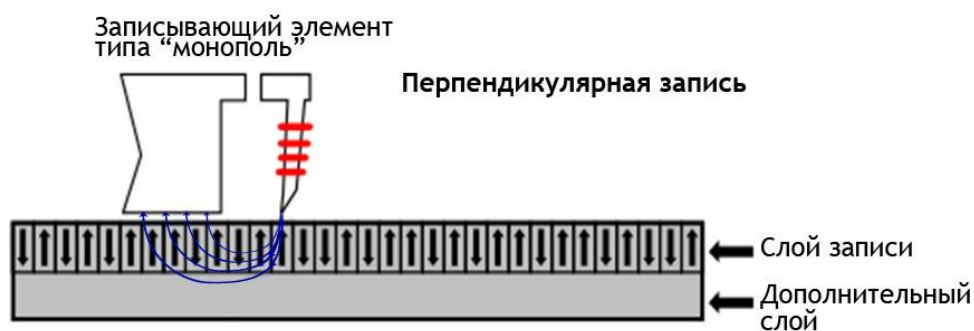
Рис. 31. Головка для перпендикулярной записи
