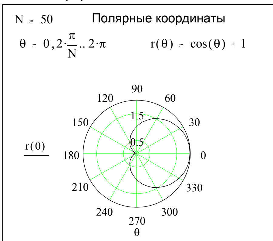
Рис.4. Пример построения графика функции r_i = \cos(\theta_i) + 1 в полярных координатах
