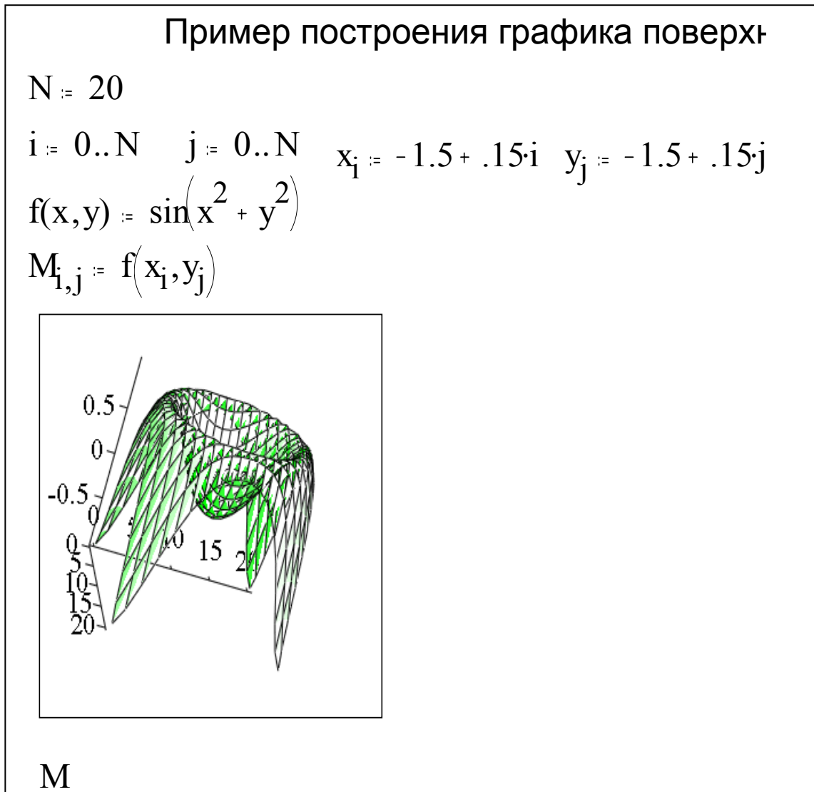
Рис. 13. Пример графика поверхности f(x,y)=\sin(x^2+y^2)
