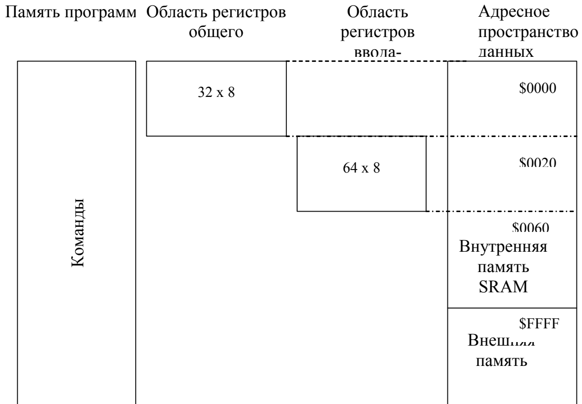
Рис.2. Распределение адресов в микроконтроллере AT90S8515.
