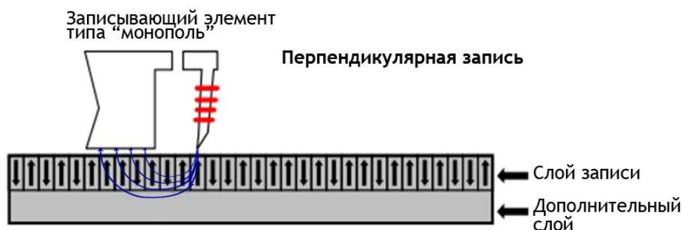
Рис. 27. Головка для перпендикулярной записи
