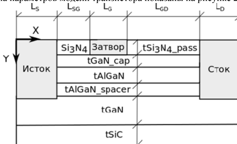
Рисунок 2. Эскиз конструкции гетероструктурного полевого транзистора. Указаны используемые в командном файле имена толщин слоев и размеров элементов вдоль поверхности кристалла.
